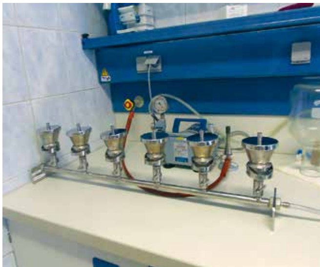
Über dieses Filtrationsgestell wird das Wasser auf sterile Filter gegeben.
