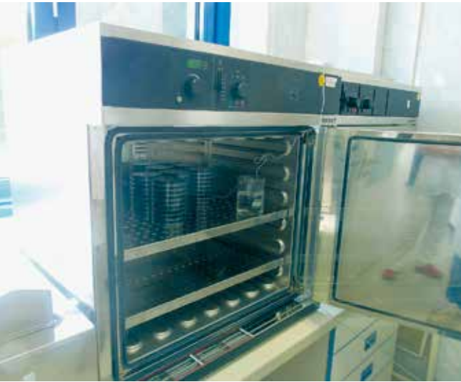
Blick in einen Brutschrank, wo die Proben für zehn Tage verbleiben.
